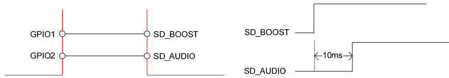
图5 控制方式一以及上电时序图
