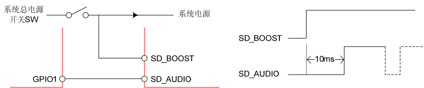
图6 控制方式二以及上电时序图
